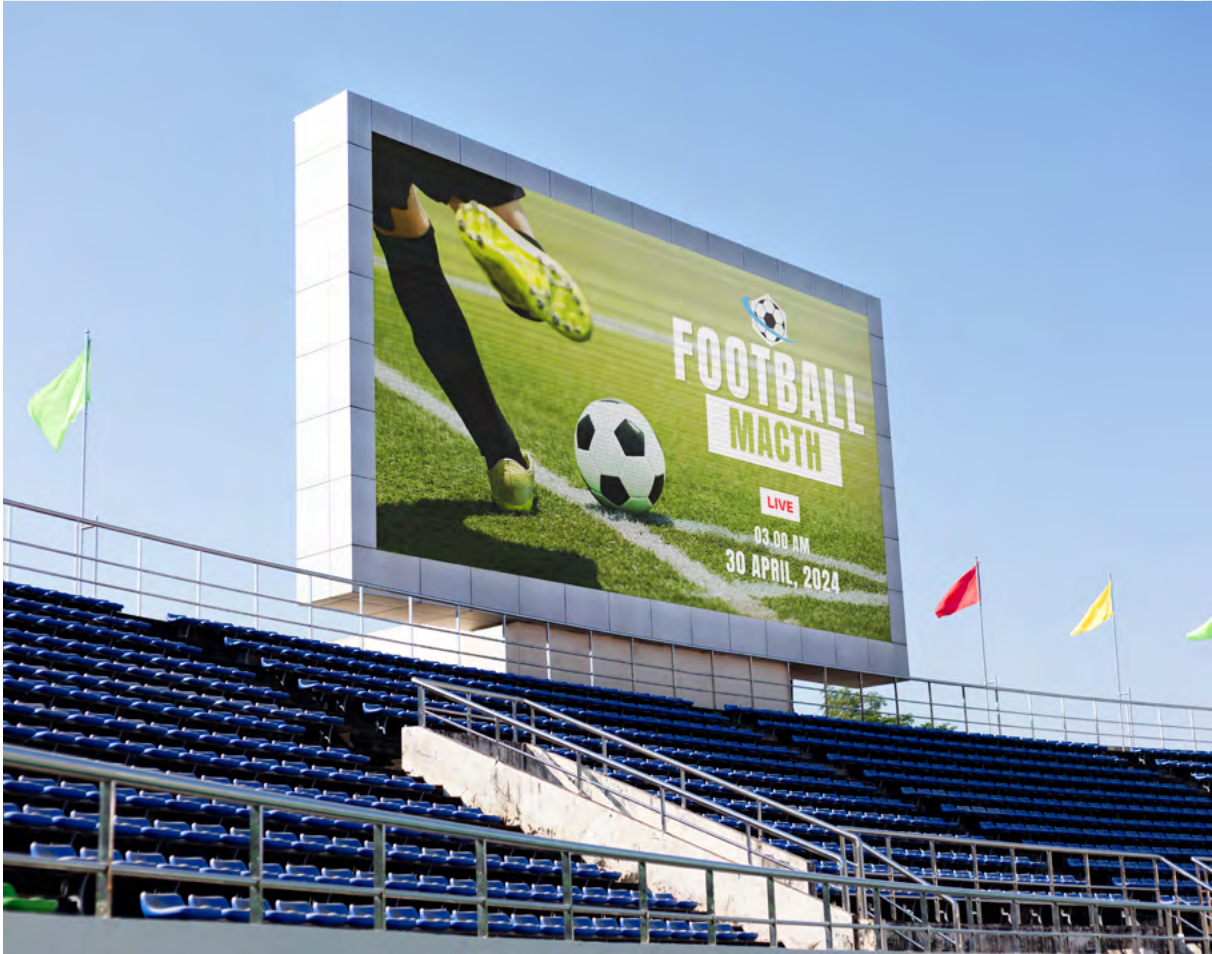
Applicazione display LED di grande formato composto da cabinet modulari per la realizzazione di uno schermo da stadio. Large format LED display application composed of modular cabinets for the creation of a stadium screen.
