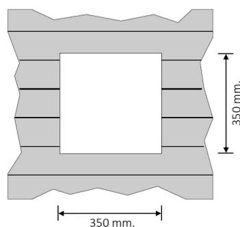
**STEP 2** - Posizionare la cornice nel foro (350x350 mm), e fissarla alla struttura sopra il controsoffitto con le 2 staffe a L.
