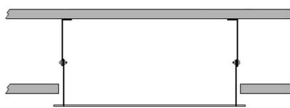
**STEP 3** - Spingere in alto la lampada a filo con il controsoffitto e bloccarla chiudendo le viti, poi collegare la linea 220Vac e infine fissare la lampada alla cornice utilizzando le viti in dotazione.
