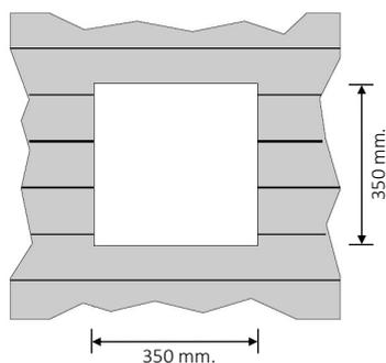
**STEP 2** - Posizionare la cornice nel foro (350x350 mm).
