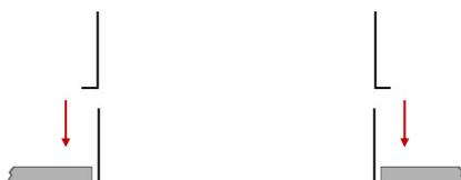
**STEP 3** - Bloccare la cornice nel controsoffitto con le 2 staffe a L in dotazione poi collegare la lampada alla linea 220Vac e fissarla alla cornice con le viti in dotazione.
