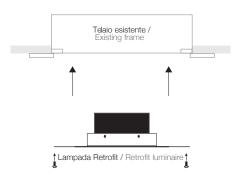
La lampada viene fornita con incluso: rondelle dentellate per filo di terra, gommini di ritenuta per viti, scatola derivazione stagna per collegamento alimentazione.
