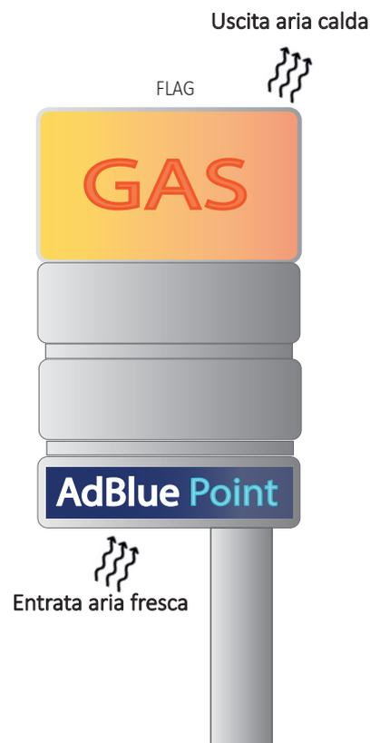
Creare uno spazio adeguato nella struttura ( Flag o monolito ), inserire il display e fissarlo con delle viti utilizzando i fori presenti nelle 2 flange. Posizionare un policarbonato frontale di protezione per la pioggia mantenendolo ad una distanza di almeno 20 mm dai LED.
