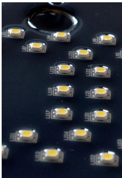
La notevole escursione termica e l'elevato tasso di umidità a cui sono sottoposti i display LED ha indotto il reparto progettazione di Hitechled a prediligere una protezione delle schede elettroniche composta da silicone puro. Questo materiale a differenza delle comuni resine protettive ha il pregio di rimanere sempre elastico e inalterato nel tempo, evitando fessurazioni e relative infiltrazioni.
